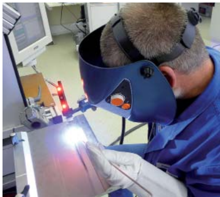
GSI-SLV-сварочный тренажёр в действии во время обучения
