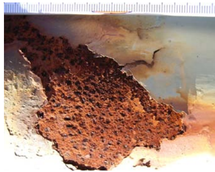
Bild: Abblätternde Beschichtung mit Narbenbildung auf der Stahloberfläche
