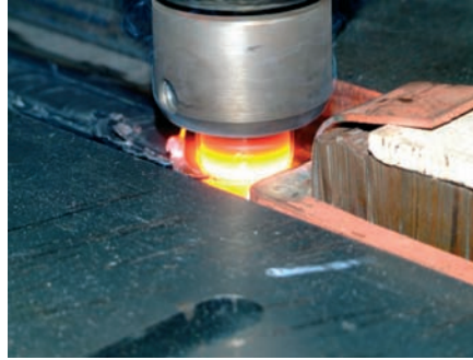
Rührreibschweißen von hochfestem Baustahl mit induktivem Vorwärmprozess
