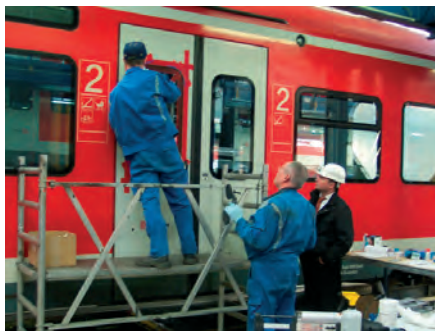
Herr Julian Band (1. v. r.) überwacht eine Klebung innerhalb der Betriebsprüfung zur DIN 6701
