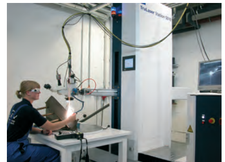
Reparatur eines Bauteiles mit TruLaserStation 5010
