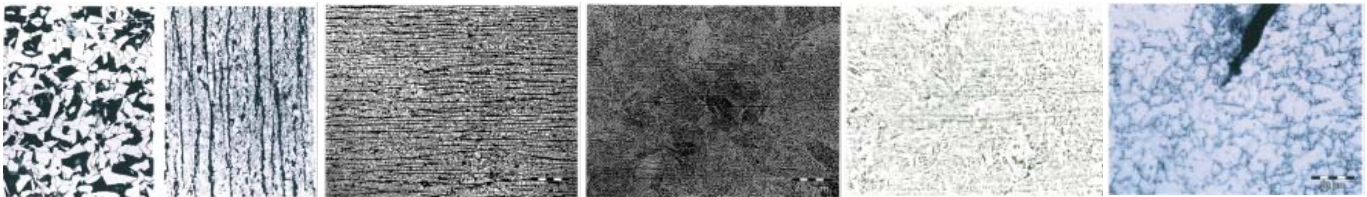
Abb. 1: „klassisch“ normalisierter unlegierter Baustahl, Festigkeitsklasse S355, li.: normalisiert; re.: normalisierend gewalzt
