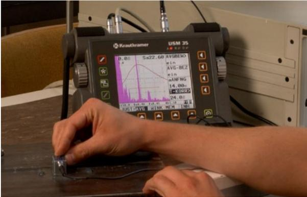
Weiterhin werden die Fertigkeiten zur Prüfung einfacher Bauteile aus Stahl und anderen Werkstoffen erworben. Nach Prüfanweisungen werden Waddickenmessungen, Blechprüfungen, Ortungen von Unregelmäßigkeiten durchgeführt und nach Vorgaben von Regelwerken protokolliert.
